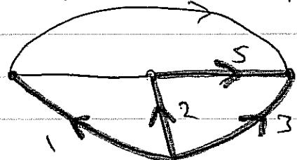
$$\text{KVL: } V_2 - V_3 + V_5 = 0$$
