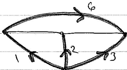
$$\text{KVL: } V_1 - V_3 + V_6 = 0$$
